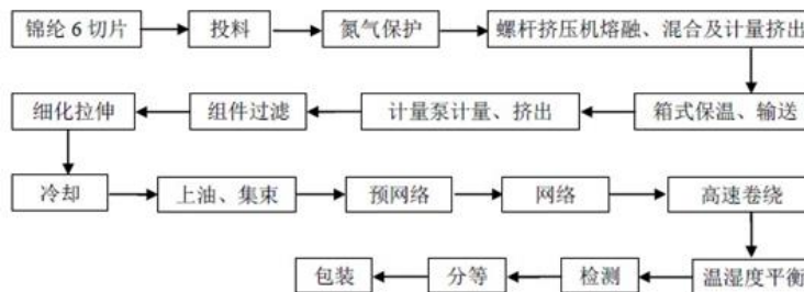
图7 公司锦纶POY生产流程
